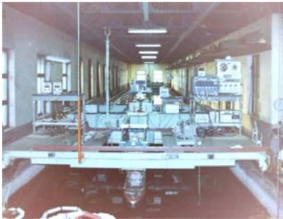
横国大の旧水槽。木製台車は鋼製の物に更新された。奥の造波機もフラップ式から、プランジャー型の竹澤のものに更新された。なつかしいDRが見える
