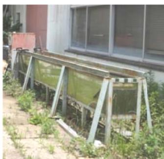
ガラス水槽の現在。学生実験の準備用として、船舶海洋工学実験棟横（屋外）に健在。
