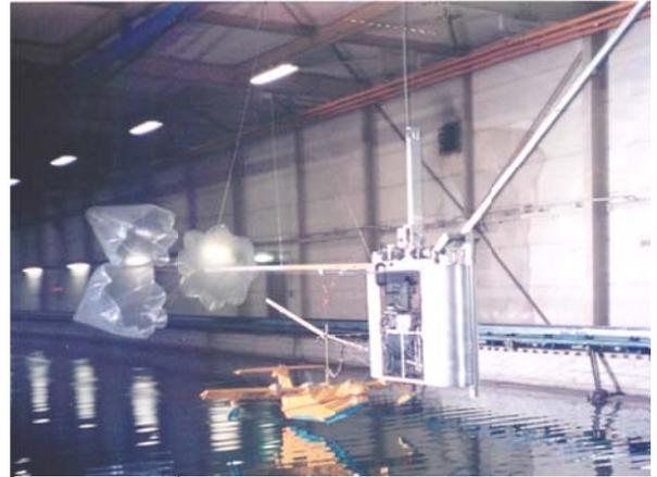
高速曳航システムによる、飛行艇モデルの着水試験。パラシュート状のものはドラッグシュートで、高揚力発生装置を模擬するためのもの。ブラジルの IPT (サンパウロ大学構内) でも導入中
