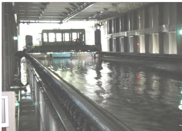
写真1 2011年3月11日。地震直後の曳航水槽。水槽幅方向(ほぼ東西方向)に定在波が励起され、天端を超えて通路(水で光っている)更には建物外に流れ出した(平川嘉昭先生が撮影したビデオ映像があります)。
